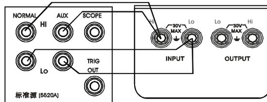
2)按 [ FUN ] 键，进入400Ω输入校准状态，并显示 ‘INPUT’ 、 ‘CAL 0’ 、 ‘ON’ 和 ‘400.0Ω’
