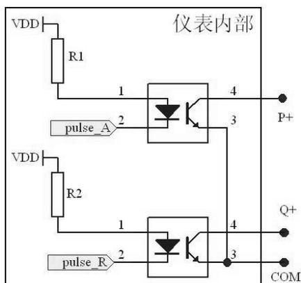
图 3.3 功率脉冲输出接口电路示意图
