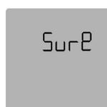
说明：在选择或输入好设置参数并按下“←”键确认后，出现“SURE”确认界面，再按“←”键一次使新参数生效。在参数设置的任意时刻，按“→”键，将取消设置或退回上一级。
