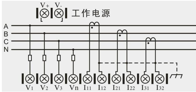
图 5.3 三相四线(无 PT)接线图
