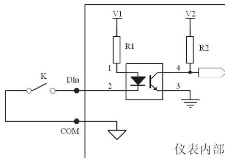
图 3.4 开关量输入接口电路示意图
