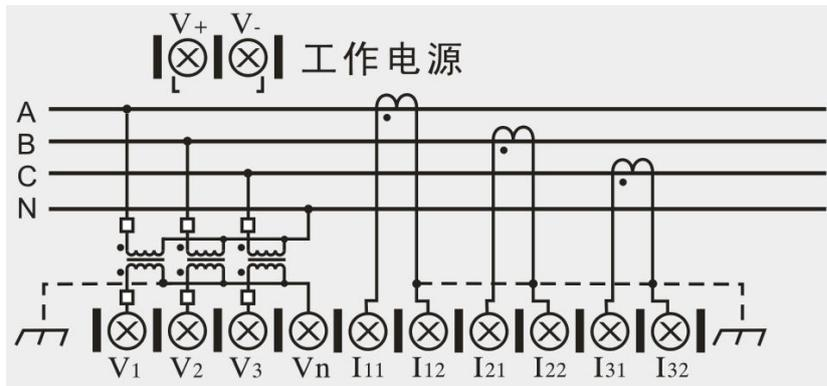
图 5.4 三相四线(带 PT)接线图
