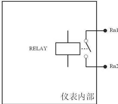
图 3.5 继电器输出接口电路示意图
