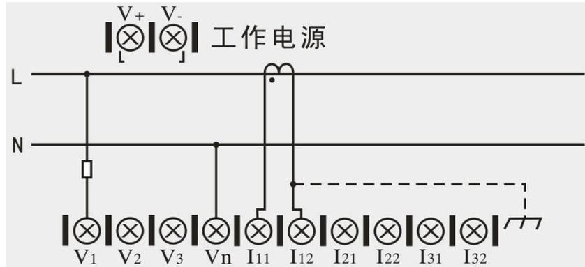
图 5.7 单相两线接线图
