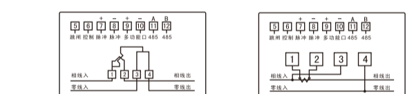
图1：直接接入式 图2：经互感器接入式
